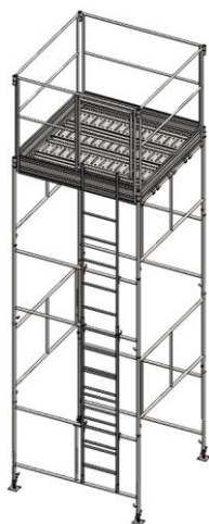
Modelo Atual de Andaime Tubular de 1,0 x 1,5 m (modelo Mecanfix)
